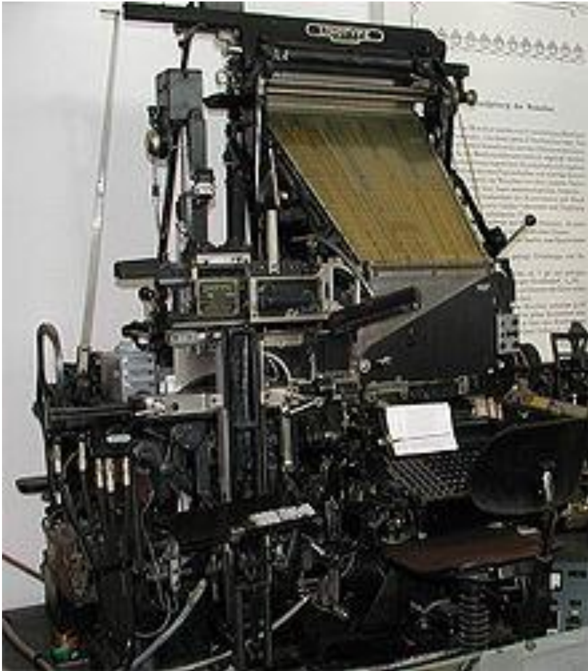
Maszyna do składu gorącego, obsługiwana przez składacza, odlewająca całe wiersze.
