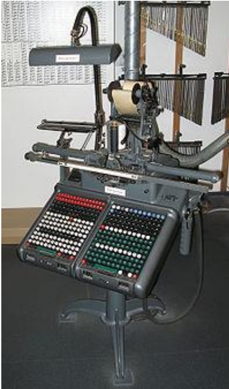
Monotyp – Maszyna do składu gorącego, obsługiwana przez składacza, odlewająca poszczególne znaki
