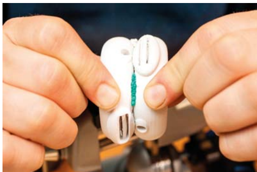
Rysunek 13.9. Zepnij obie części i pozwól im wystygnąć
