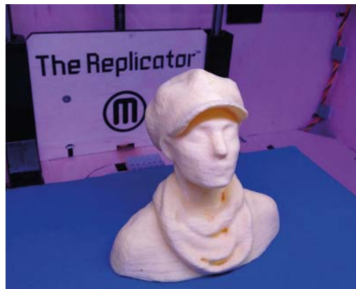
Rysunek 6.23. Drukowana wersja skanu utworzonego za pomocą aplikacji ReconstructMe
