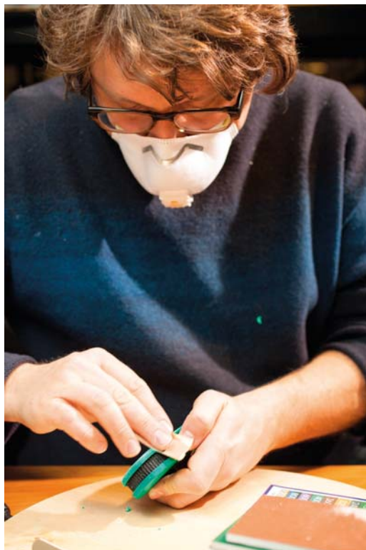
Rysunek 13.18. Szlifowanie wydruku 3D
