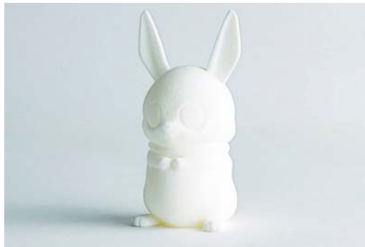
Rysunek 9.3. Proszek nylonowy scalony metodą selektywnego spiekania laserowego
