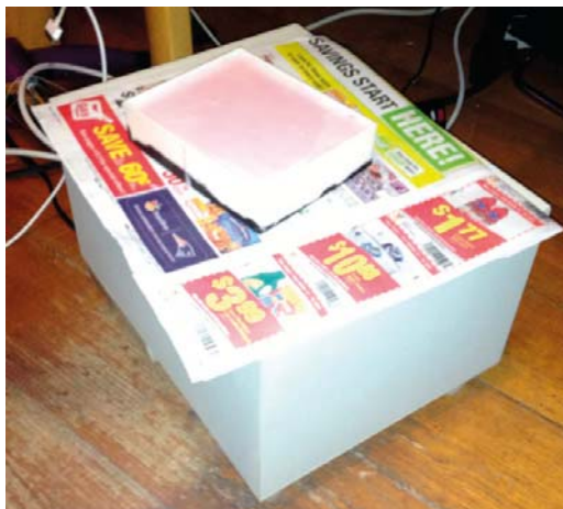
Rysunek 21.7. Uwalnianie pęcherzyków za pomocą subwoofera
