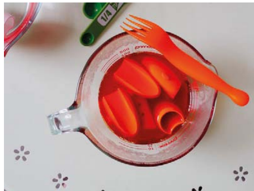
Rysunek 12.7. Wrzucić wydruki do roztworu
