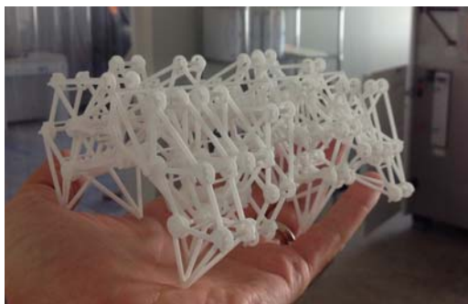
Rysunek 11.1. Mechaniczny potwór płazowy wymyślony przez Theo Jansena, a wydrukowany z nylonu na maszynie EOS metodą selektywnego spiekania laserowego (SLS) w nowojorskim oddziale firmy Shapeways. Po wyczyszczeniu będzie gotowy do spacerowania
