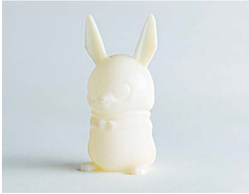
Rysunek 9.4. Króliczek wydrukowany z akrylu utwardzanego promieniami UV
