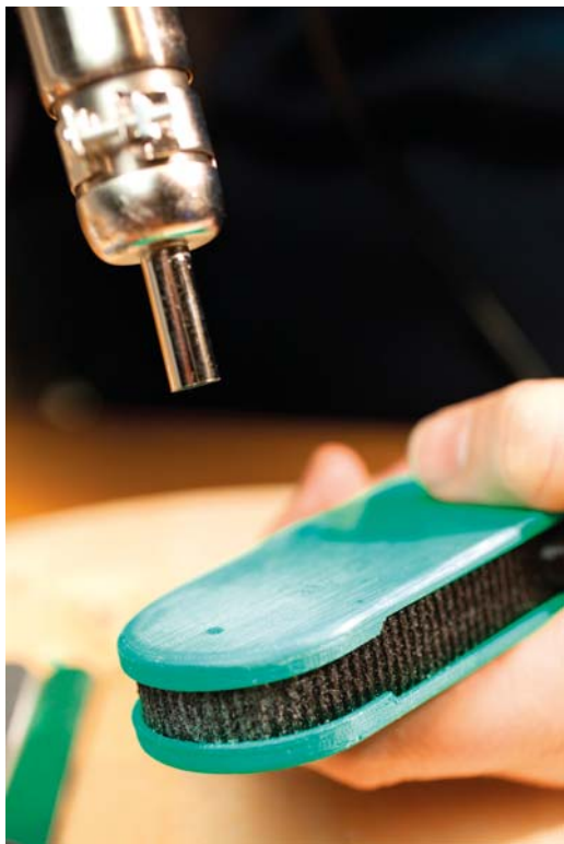
Rysunek 13.21. Do likwidowania małych zadrapań użyj opalarki
