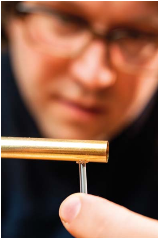
Rysunek 13.17. Osłoń grot lutownicy mosiężną rurką
