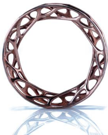
Rysunek 3.3. Bransoletka „Convolution” (splot) wykonana ze stali nierdzewnej w studiu Nervous System jako rezultat symulacji sił w sieci komórek
