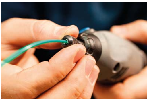
Rysunek 13.3. Zamocuj filament w uchwycie narzędzia
